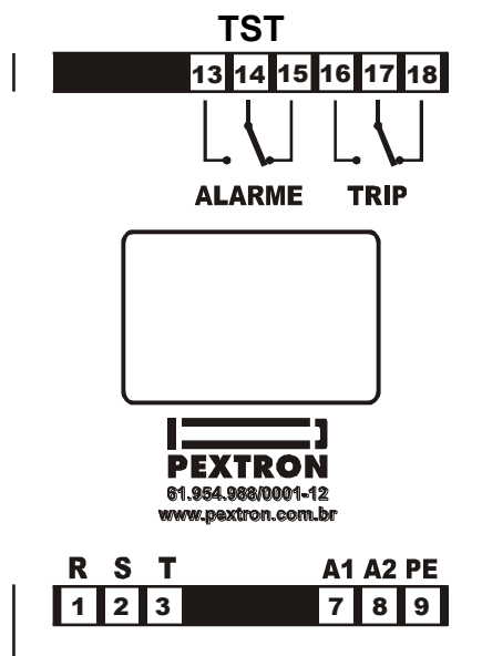
Figura 3: Identificação de bornes TST.
